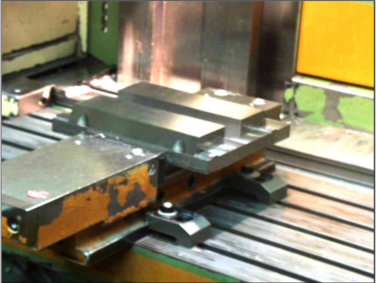
Abb. 8: Rüsten der Werkzeugmaschine, Einsatz der Spannvorrichtung
